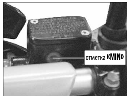
Передний бачок с тормозной жидкостью.
