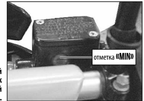
Передний бачок с тормозной жидкостью.
